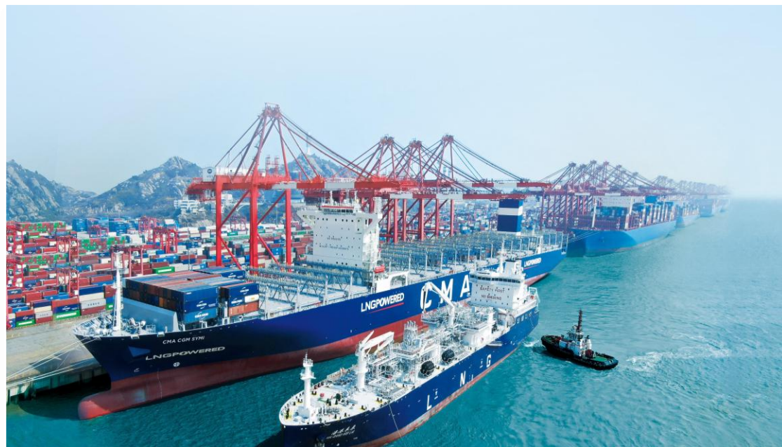
船舶LNG同步作业加注 LNG SIMOPS Bunkering
